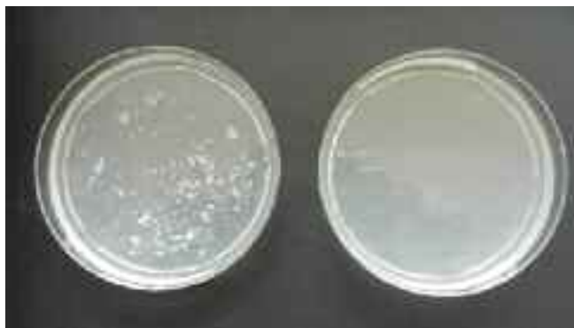
Linke Platte mit Wasser, rechte mit Nanosilber-Lösung.
