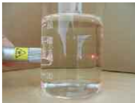
Der sichtbare Strahl des Laserpointers beweist die Existenz von Nanosilber.
